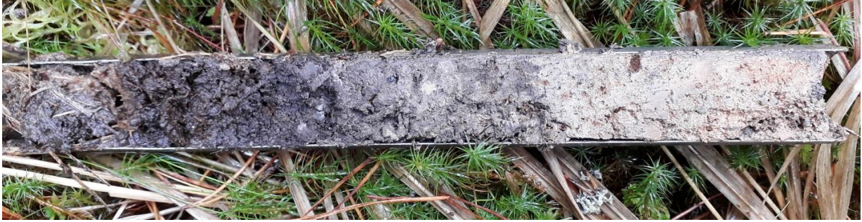
Abb. 3: Profil Hagenmoos Südost, Pseudogley, Torf über Sw mit Rostflecken / Konkretionen.
