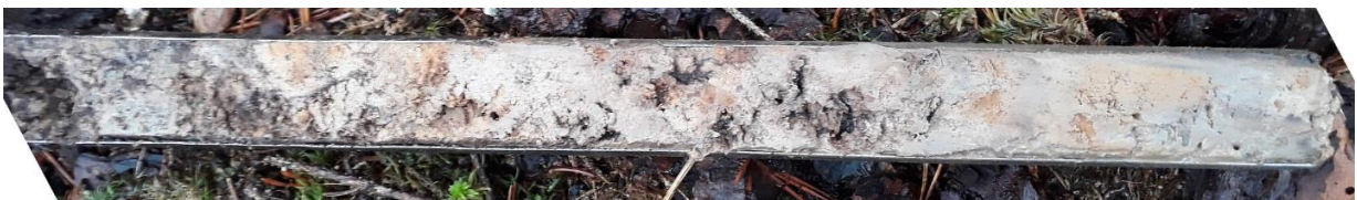
Abb. 7: Profil Nordostbereich im Hagenmoos, Lehm mit Bleichung und Rostflecken.
