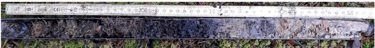
Abb. 6: Profil Südostteil im Hagenmoos, Sphagnumtorf über Brandschicht über rostfleckigem Sw.
