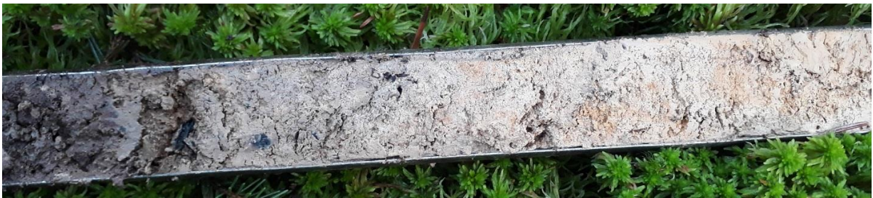
Abb. 5: Profil mittlerer Bereich des Hagenmoos, Pseudogley, Sw-Horizont mit Mangan-Konkretionen und Rostflecken.
